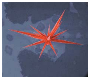
Рис. 50. Изображение наночастицы оксида цинка \text{ZnO} , полученное с помощью электронного микроскопа
